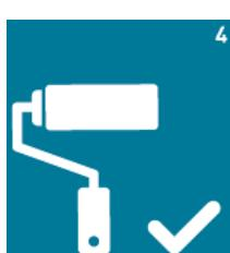
**Шаг 4.** Валиком распределите грунт по поверхности пола. К нанесению следующего слоя приступайте после полного высыхания загрунтованной поверхности, но не ранее чем через 24 часа.
