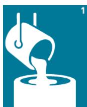
**Шаг 1.** Добавьте отвердитель покрытия (компонент B2) в базу покрытия (компонент A2).
