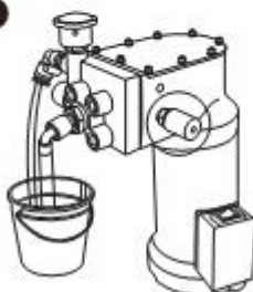
Поверните регулятор давления на LOW (до упора против часовой стрелки)
