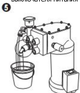
Присоедините сборку всасывания
