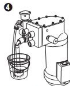
Трубка всасывания и обходная трубки остаются в ведре, их концы ниже уровня краски
