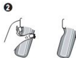
Активируйте предохранитель курка
