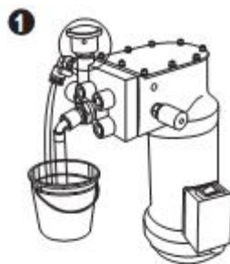
Переведите регулятор PRIME/SPRAY в положение PRIME
