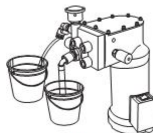
Погрузите сборку всасывания в раствор
