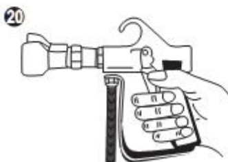
Нажмите на спусковой механизм распылителя со снятым предохранителем
