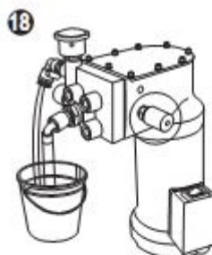
Поверните регулятор давления в положение LOW (до упора против часовой стрелки)
