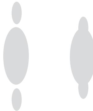
След от распыления жидкости под низким давлением без помощи воздуха
