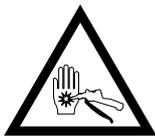
Из данного пистолета жидкость выходит под высоким давлением. Существует опасность попадания жидкости под высоким давлением под кожу и в организм человека, вызывая при этом тяжёлые травмы, которые могут даже послужить причиной для ампутации. Кроме того, попавшая в глаза или на кожу жидкость может вызвать серьёзные травмы.
