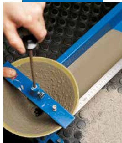
Испытание расширения в канавке согласно норме UNI 8997/89
