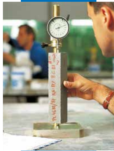
Определение расширения в стесненных условиях согласно норме UNI 8147/80
