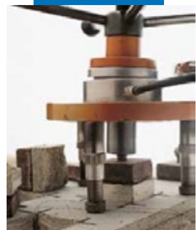
Испытание на адгезию SATTEC
