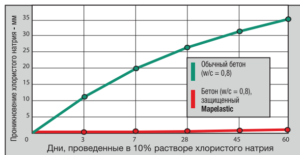
Рисунок 3. Защита пористого бетона с помощью Mapelastic от проникновения хлорида натрия
